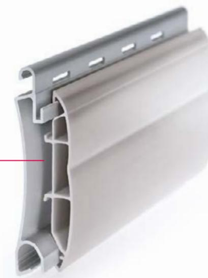
BLINDOPLAST è un'avvolgibile di sicurezza in alluminio estruso con rivestimento esterno in PVC. È possibile l'inserimento di catenaccio di sicurezza sia nel terminale di fondo (in alluminio estruso) che nelle stecche intermedie. Il profilo scatolato, serve anche da rinforzo per le aperture maggiori, su guide fisse a partire da cm 190 di larghezza, su sporgere a partire da cm. 150.
